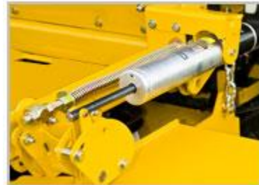
El-hydraulisk højderegulering til 54, 60 og 72"
