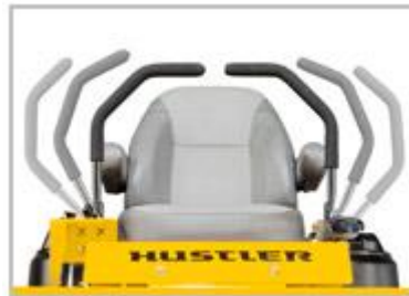
Patenteret parkeringsbremse indbygget i styrstængerne
