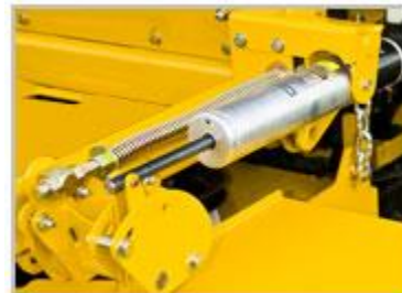
El-hydraulisk højderegulering til 54, 60 og 72"
