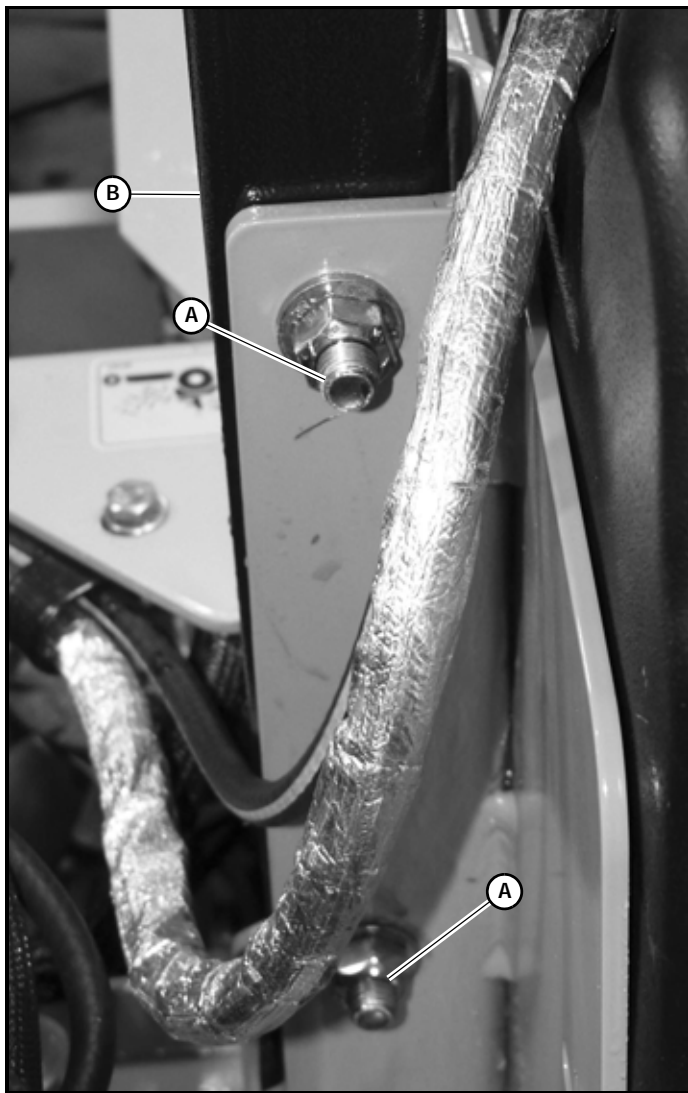
A. Monteringsbolte til styrtbøjle B. Styrtbøjle
