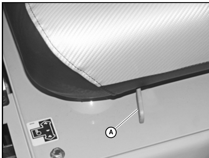
A. Levier de déplacement vers l'avant et vers le haut
